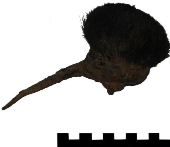
Figuur 19 Restant van een bokkenpoot voor het teren (schaalverdeling 10cm).
