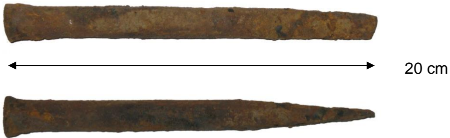
Figuur 18a Stalen bevestigingspen met een platte punt.
