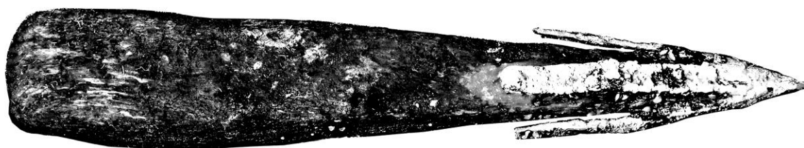
afbeelding 6: de gevonden paal met paalschoen
