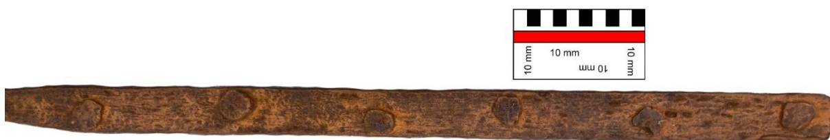
Afbeelding B Uiteinde muuranker met spijkerkoppen. Bovenaanzicht
